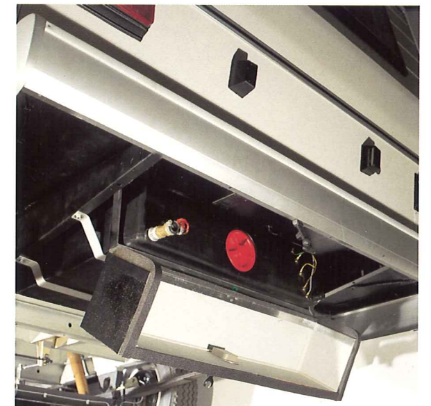
Isolierter und beheizter Abwassertank für höchsten Komfort.
