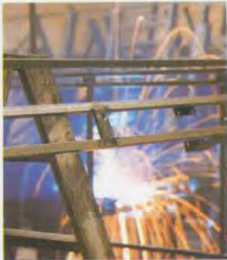
Geschweißter Stahlprofilrahmen des Hytermobils.
