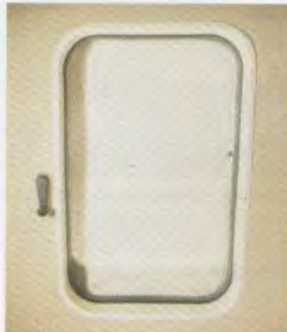
Großvolumiger, stufenlos verstellbarer und weit überragender Eriba-Hymer-Kurbeldachlüfter mit integrierter Isolationsmatte.
